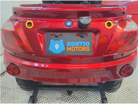
irrota takakatteen kiinnityspultit. (hylsy 8 mm).
